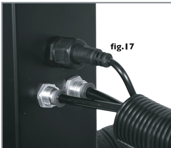
L'innesto dei tubi di acqua **b** & **c** avviene semplicemente inserendo a fondo i tubi negli appositi alloggiamenti. In caso sia necessario disconnetterli è sufficiente premere l'anello di plastica azzurro verso l'interno e sfilare il tubo.
