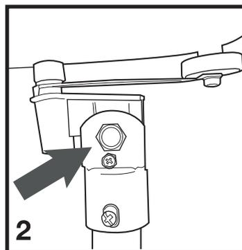
Regolare l'inclinazione della testa, allentando il bullone (fig.2). Una volta raggiunta l'inclinazione desiderata, serrare il bullone e avvitarla vite di sicurezza, per bloccarne la posizione.
