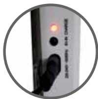
Spia LED indicatore di ricarica batteria e della funzione di emergenza inserita.
