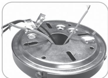
Collegare i tre fili che escono dal corpo motore ai cavi che escono dal soffitto tramite una morsetteria. È fondamentale individuare il cavo **Neutro** e i cavi **Fase** che escono dal soffitto. **L'errato collegamento della Fase o Neutro può causare un cortocircuito e danneggiare irreparabilmente il motore del ventilatore.**
