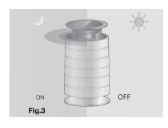
3. Modalità intelligente: il sensore crepuscolare fa sì che l'apparecchio si accenda autonomamente nelle ore serali e notture o in assenza di luce e si spenga in automatico nelle ore diurne o in presenza di luce.
