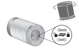
4. Riposizionare l'imbuto nel cestello, riposizionare quest'ultimo all'interno dell'apparecchio e bloccarlo ruotando delicatamente nel senso opposto dell'apertura. Prendere la parte superiore dell'apparecchio e unirla a quella inferiore ruotando in senso orario (verso " • lock / blocca"), fino allo scatto.
