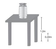
1. Posizionare l'apparecchio da 0,4 m a 1,2 m da terra. Evitare interferenze con altre fonti di luce.
