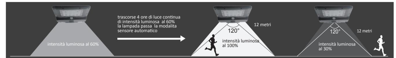
**Modalità B - Sensore Automatico** - (settaggio di fabbrica. Modifiche possibili tramite telecomando)
