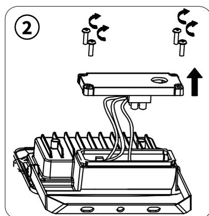
2 - Aprire con un cacciavite a croce il coperchio della scatola per la connessione, posta sul retro del proiettore per accedere alla morsettieria.
