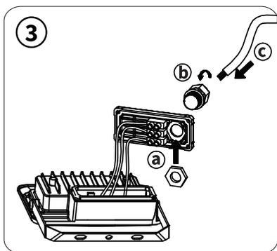
3 - Installare il pressacavo in dotazione (b) nell'apposito foro del coperchio ed avvitare nel lato interno del coperchio con il dado in dotazione (a). Inserire il cavo di alimentazione (c - 1,0 mm<sup>2</sup> non fornito) attraverso il pressacavo e la guarnizione in gomma: controllare che l'anello di tenuta sia sufficientemente stretto.
