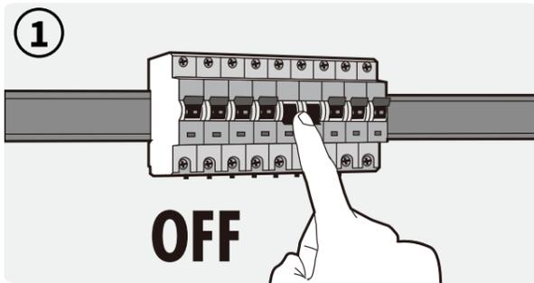
Figura 1- Disattivare la corrente alle linee elettriche dove l'apparecchio verrà installato.
