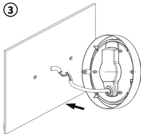
Figura 3 – operare la connessione dei cavi di alimentazione, facendo attenzione a collegare in modo corretto i rispettivi cavi di Fase e Neutro.
