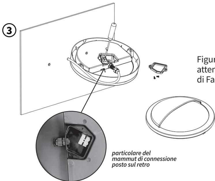
Figura 4 – Chiudere il vano di connessione con le viti facendo attenzione che la guarnizione sia nella posizione corretta
