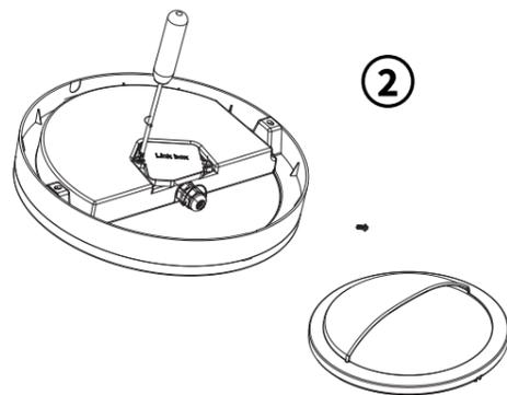
Figura 3 – Connettere i cavi di alimentazione, facendo attenzione a collegare in modo corretto i rispettivi cavi di Fase, Neutro e Terra
