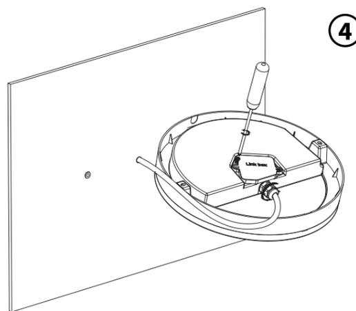
Figura 5 – Fissare l'apparecchio al muro con le viti dei tasselli precedentemente predisposti
