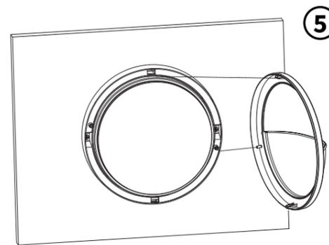
Figura 5 - Montare la cornice ad incastro
