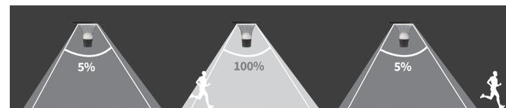
metri, nel raggio di circa 120°, la lampada si accende alla massima luminosità (2200 lumen). Passati 20 secondi in assenza di movimento la lampada riattiverà la luce a bassa intensità (5%). Il sensore radar è posizionato sotto al pannello e indicato con il simbolo . Posizionare il simbolo rivolto verso la zona dove è presunto il passaggio abituale.
