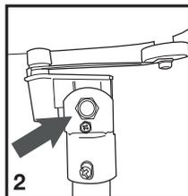
Regolare l'inclinazione della testa, allentando il bullone (fig.2). Una volta raggiunta l'inclinazione desiderata, serrare il bullone e avvitare la vite di sicurezza, per bloccarne la posizione.
