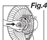
Inserire le pale sull'albero motore stringendo la vite di fissaggio anteriore. La vite ha filettatura sinistra. Vedi **Fig.5**
