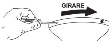
Agganciare la coppa di copertura alla flangia di sostegno fissata al muro tramite le viti che sono presenti lungo il perimetro della flangia di sostegno.
