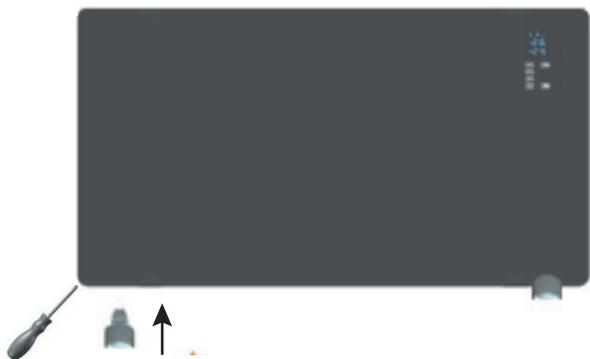
1. Procedere installando i piedini alla base del riscaldatore e fissarli con le 8 viti ST12x4mm in dotazione.
